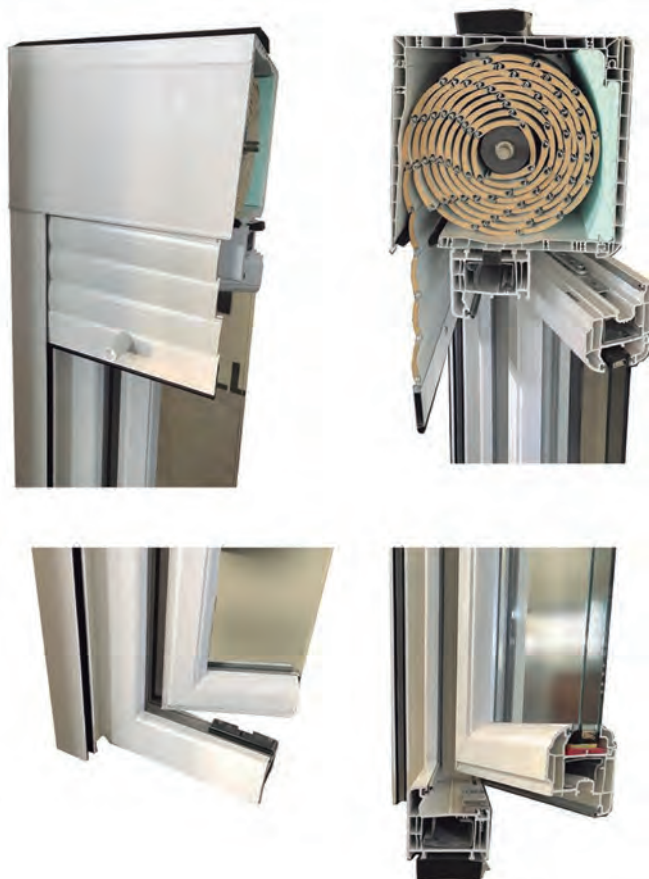
Figura 64. Fotografía desde distintos puntos de vista de muestra de cajón y ventana, seccionadas mostrando el interior. De izq. a dcha. y de arriba abajo: vista desde el exterior de la esquina sup. izq., vista de la unión del cajón y la ventana (nótese que se han presentado, sin adherir, cinta expansiva en la zona superior del cajón), vista desde el exterior de la esquina inf. izq., detalle zona inferior (con cinta expansiva presentada)
