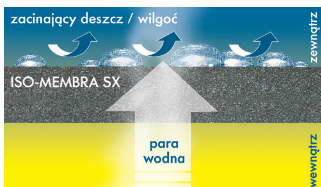
Zasada działania membrany uszczelniającej
