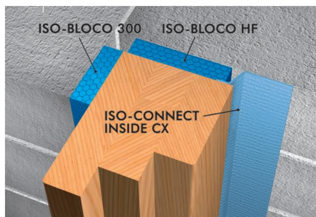
Ejemplo de instalación: SISTEMA DE SELLADO DE VENTANAS ISO<sup>3</sup>
