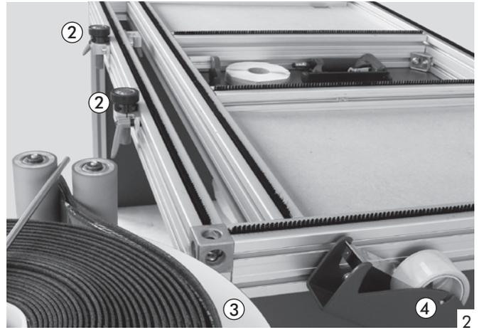
muss der Rahmen fixiert werden. Besonders eignen sich dazu Rollenanschlüsse ②. Die Rollen können entweder im Rahmen am Rahmenüberschlag anliegen oder gegenüberliegend am Montagetisch angebracht sein.
