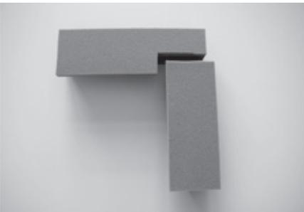
ISO-BLOCO FILLER kann in den Fugen auf Stoß verlängert werden. Für eine dichte Stoßverbindung am Dichtbandsteg muss auch hier das angesetzte Füllblockprofil ca. 2mm kürzer geschnitten werden, um einen definierten Druck zwischen den Dichtbandstreifen zu erreichen.
