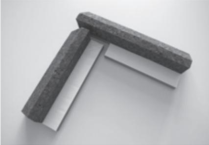
Für eine dichte Stoßverbindung am Dichtbandsteg muss das Füllblockprofil der senkrechten, seitlichen ISO-BLOCO FILLER Profilstücke 2mm kürzer geschnitten werden, um einen definierten Druck zwischen den Dichtbandstreifen zu erreichen.
