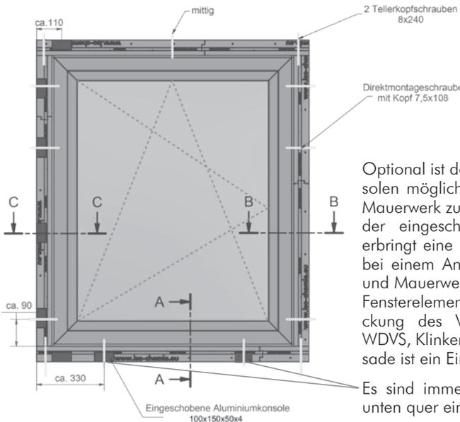
Optional ist der Einsatz von Aluminiumkonsolen möglich, um die Anbindung an das Mauerwerk zu optimieren. Die Verwendung der eingeschobenen Aluminiumkonsolen erbringt eine höhere Festigkeitsanbindung, bei einem Angriffsversuch zwischen Zarge und Mauerwerk und zwischen Baufuge und Fensterelement. Bei vollständiger Überdeckung des Vorwandmontagesystems mit WDVS, Klinkerschale oder Vorgesetzter Fassade ist ein Einsatz nicht vorgesehen.
