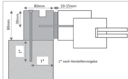
Die seitlichen Systemkanten stehen an beiden Seiten auf der unteren waagerechten Systemkante auf. Bei der Montage der seitlichen Systemkante muss eine Verklebung in den Stoßflächen erfolgen. Die Verklebung mit dem Systemkleber ISO-TOP FLEKKLEBER WF ist notwendig, um eine luftdichte Einbauebene zu erreichen. In den Eckverbindungen soll immer
